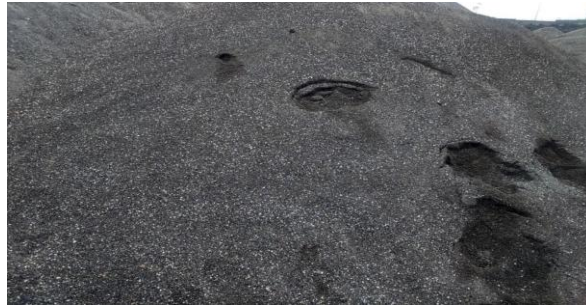
Fig.1. Iron Slag Sand
